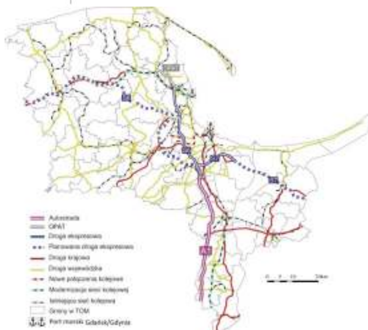
Ryc. 6.4. Kluczowe obiekty infrastruktury liniowej i punktowej na obszarze TOM wraz z planowanymi inwestycjami
